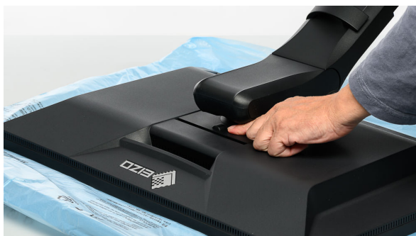
Montage van de steunpoot
