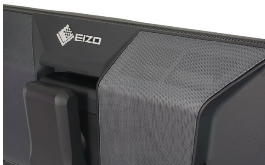
Achterkant van de EIZO CG2700S met de geperforeerde plaat
