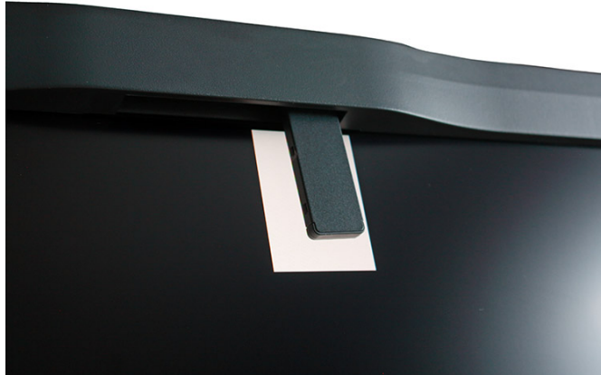
Het ingebouwde meetapparaat in actie
