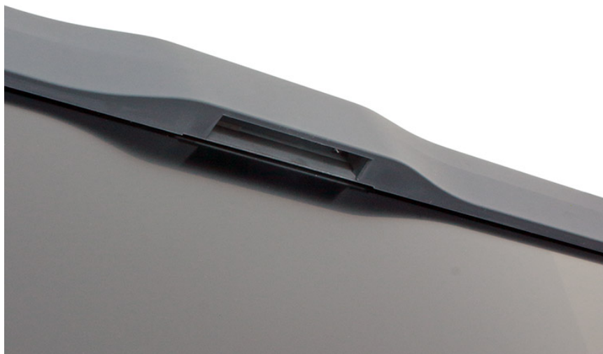
De ingebouwde meetinrichting in ingetrokken toestand
